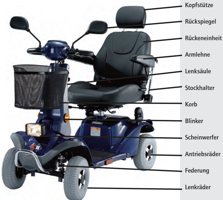
Abb. 1, (Rapid 2, Paseo ohne Kopfstütze, Spiegel rechts, Stockhalter und Positionsfahne)
